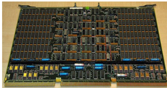
4MiB de memoria RAM para un computador VAX de finales de los 70. Los integrados de memoria DRAM están agrupados arriba a derecha e izquierda.
